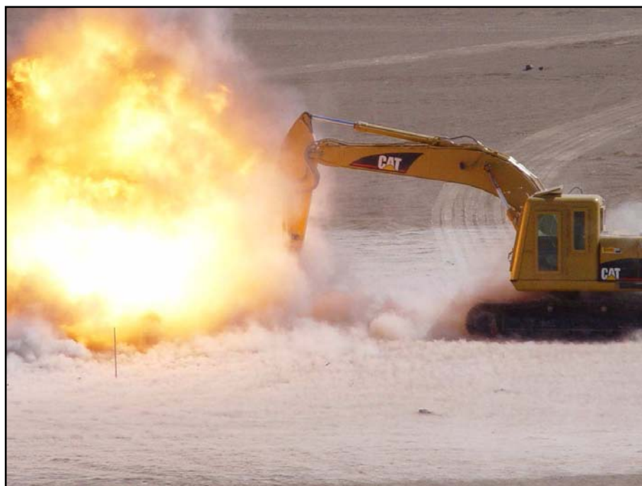
Máquina de Desminado Sifting Excavator en Arica, Prueba de detonación de mina antitanque,
