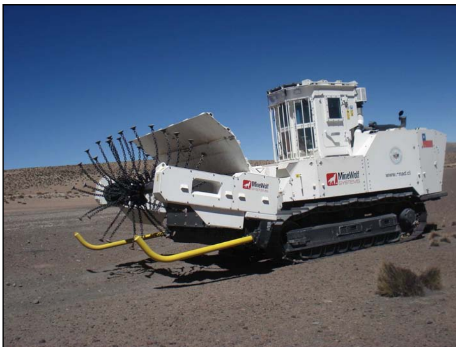
Máquina de Desminado Minewolf en Sector Tambo Quemado, Región de Arica y Parinacota,
