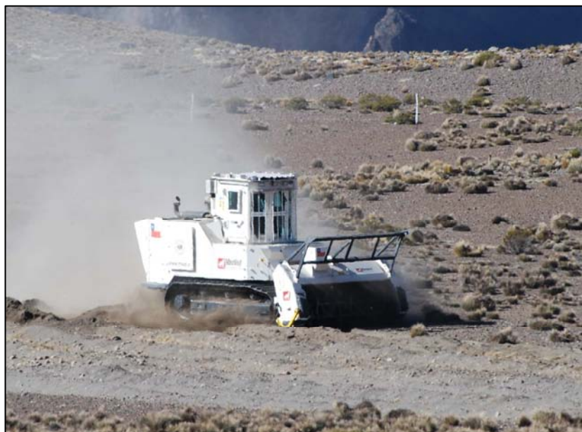
Fig. 7: Máquina de Desminado MineWolf 370, trabajando en el Sector Tambo Quemado, en la frontera con Bolivia
