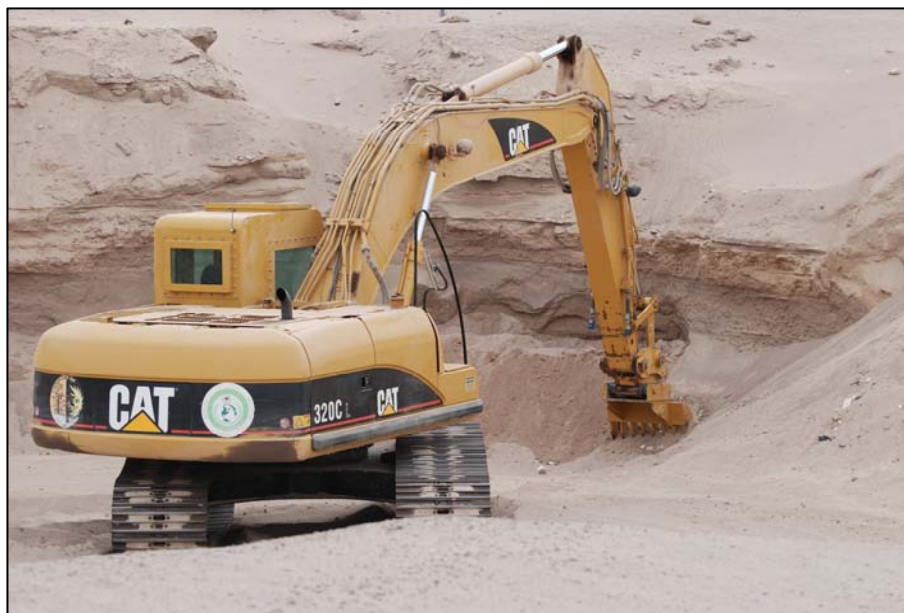
Fig. 6: Máquina de desminado Sifting Excavator, facilitada por el programa HD R&D del US DoD
